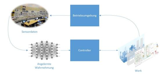
Ein auf maschinellem Lernen basierender Klassifizierer wird verwendet, um Prozesse im Produktionsumfeld zu erkennen und zu steuern. Nachgestellt aus (<u>Dreossi et al. 2018</u>).
